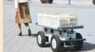
◀ 人を追従する運搬ロボット「EfiBOT」は最大300kgの荷物を運べる
